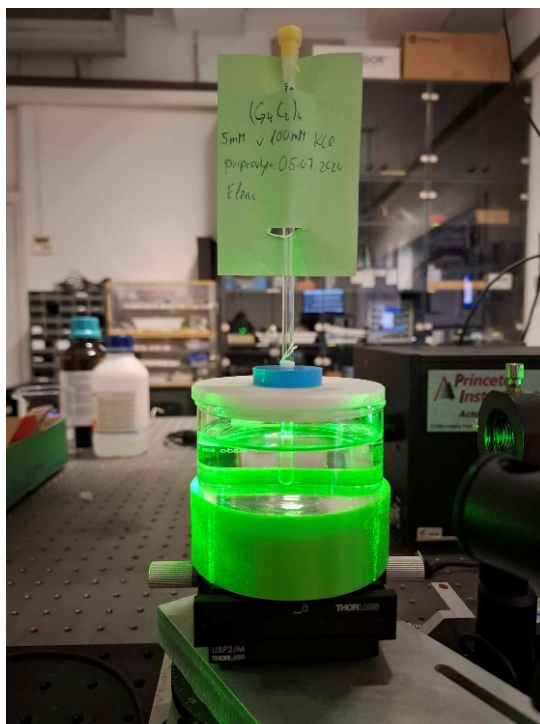
Slika 5. Vzorec v stekleni cevki, postavljeni v valjasto posodo z vodo, ki zmanjšuje učinek lečenja med stenami cevke in okolice.
